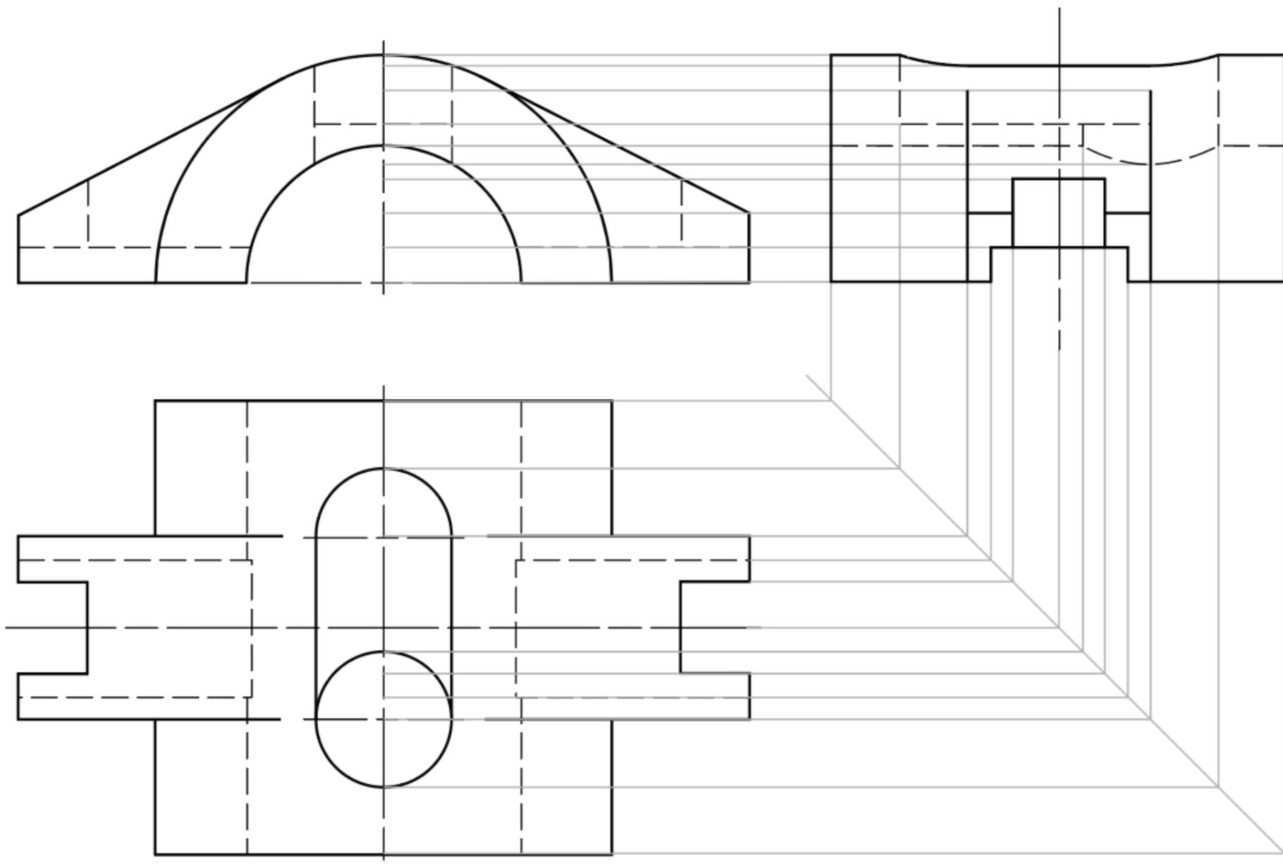
【评分细则】 半圆柱体 2 分，前后向半圆柱孔 2 分；底部左右向长槽 2 分；左右两板及挖切 4 分；中间长圆形槽 3 分；直立小圆柱孔 3 分；两者之间的分界面 2 分
