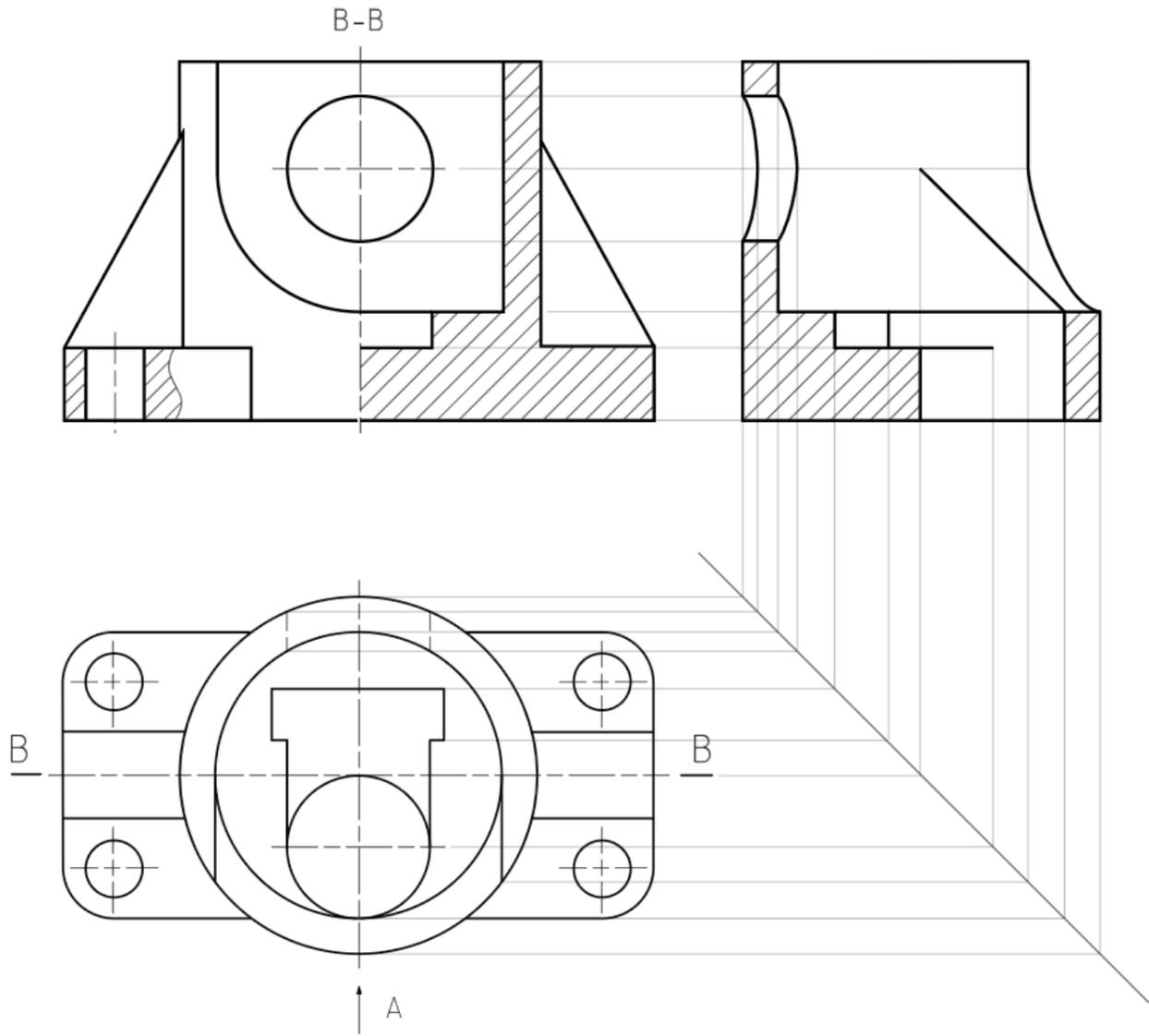
【评分标准】 半剖主视图：上部圆柱孔 1 分；肋板剖切表达 2 分；中间挖切凹槽 2 分；其余外形 1 分；
